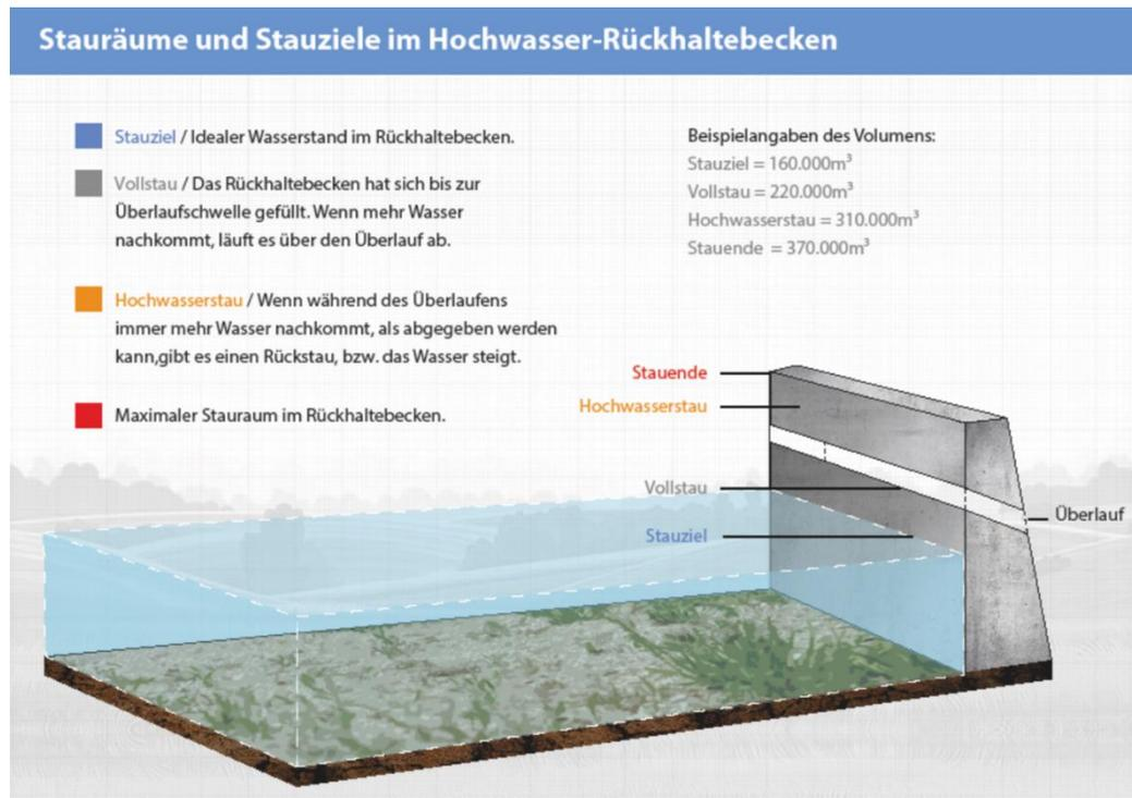
Die Aufgabe von Hochwasserrückhaltebecken ist im Falle von langanhaltendem, ergiebigem Regen das Wasser in einem Fluss zurückzuhalten und somit die Gefahr von Überschwemmungen und Schäden im weiteren Flussverlauf und tieferliegenden Gebieten zu reduzieren. Stauräume und Stauziele sind wichtige Elemente im Zusammenhang mit Hochwasserrückhaltebecken. In einem Hochwasserrückhaltebecken gibt es unterschiedliche Stauziele und damit im Zusammenhang stehende Stauräume und Stauvolumina.
